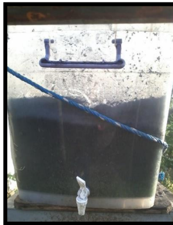
Fotografía 4. Cubeta llena de material filtrante y llave de salida de agua filtrada.
