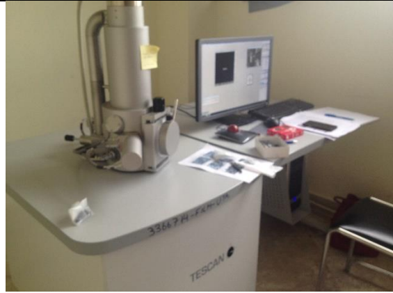
16. Análisis de la grava en el Microscopio Tescan Vega 3
