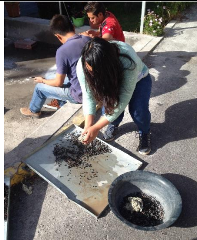
4. Ensayo de densidad de la grava
