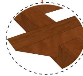
Ensamble vigas principales con el marco
