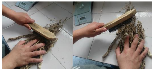
Figura 4.6 limpieza de fibra
