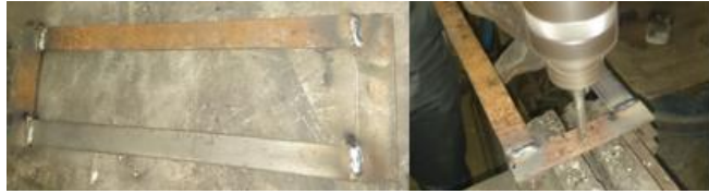
Figura 4.10. Molde para ensayos a impacto
