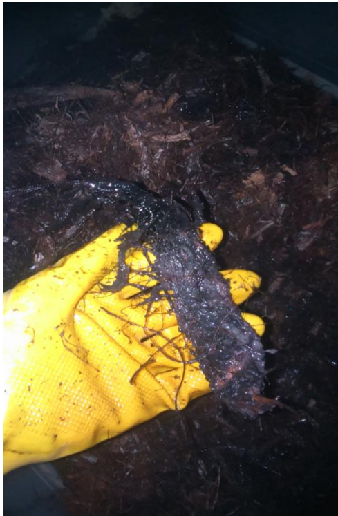
Imagen 14.- Estado de la Fibra a los 45 días de Funcionamiento del Filtro.
