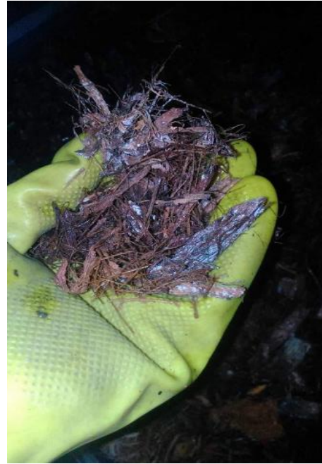
Imagen 13.- Estado de la Fibra a los 25 días de Funcionamiento del Filtro.
