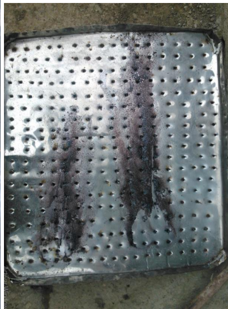
Imagen 11.- Acumulación de Sedimentos en la Placa Superior.
