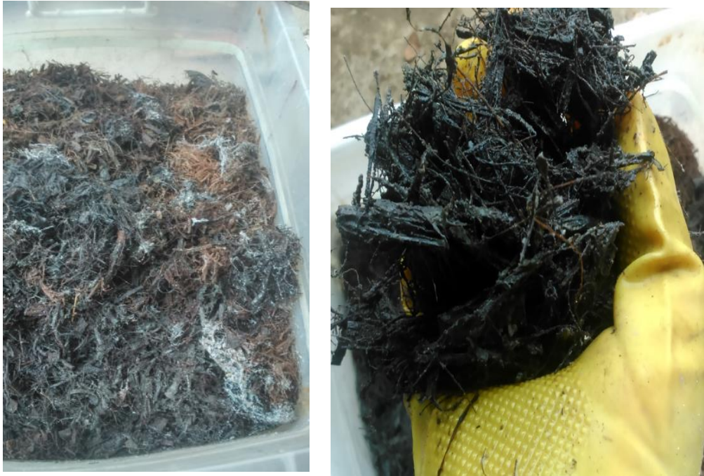
Imagen 16.- Estado de la Fibra a los 82 días de Funcionamiento del Filtro.
