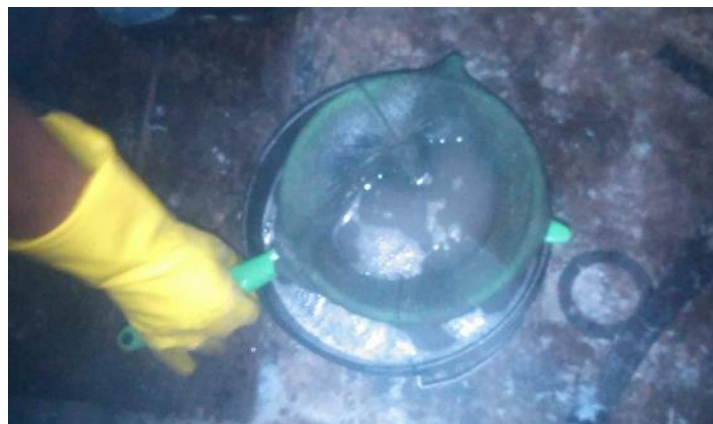
Imagen 8.- Pre filtrado del Agua Residual Antes de ser Colocada en el Tanque de Abastecimiento.
