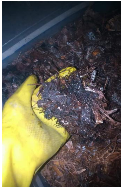
Imagen 15.- Estado de la Fibra a los 60 días de Funcionamiento del Filtro.
