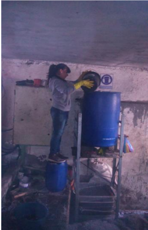
Imagen 9.- Llenado del Tanque de Abastecimiento del Filtro.
