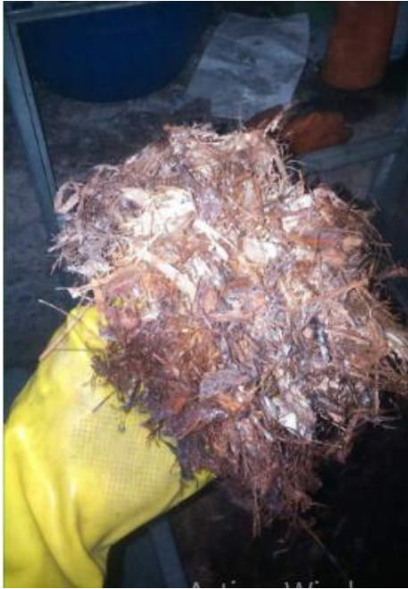
Imagen 12.- Estado de la Fibra a los 15 días de Funcionamiento del Filtro.
