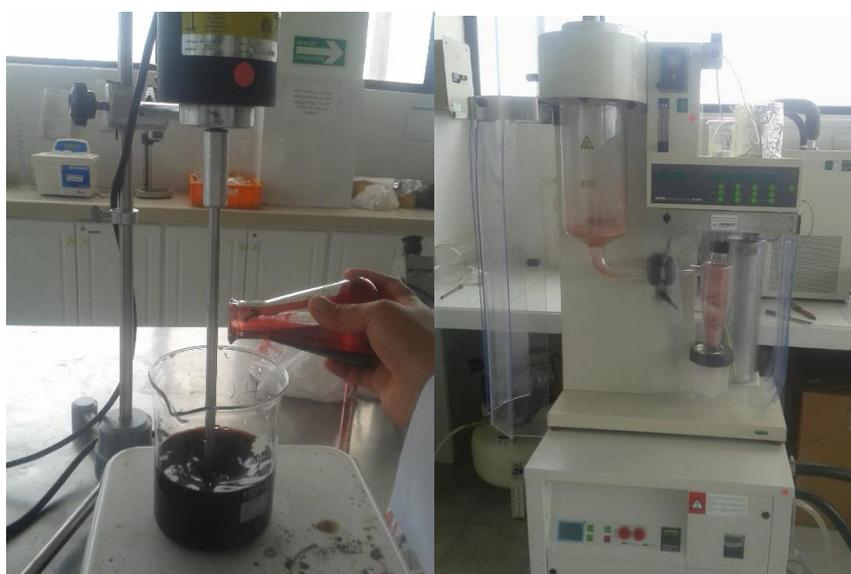
**Figura 14** Preparación de concentrado y encapsulación
