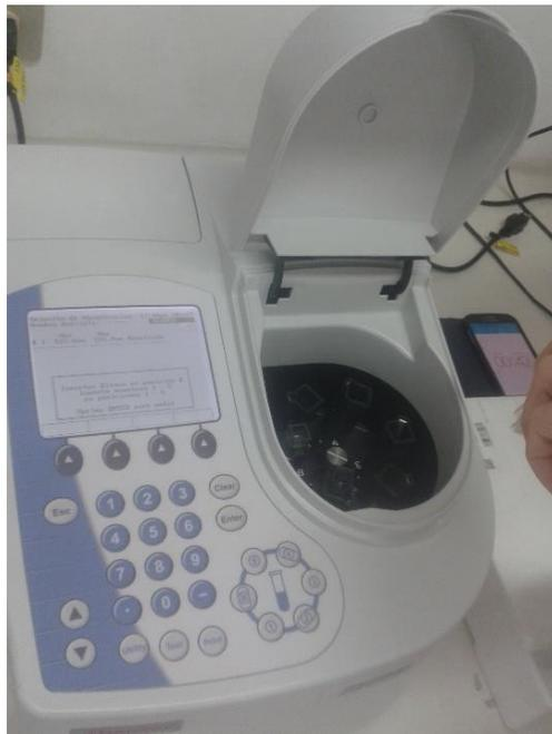
**Figura 18** Medición de absorbancia a 515 nm
