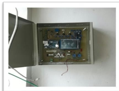
Figura 4.17 Montaje del sistema SmartHome en la pared de la residencia
