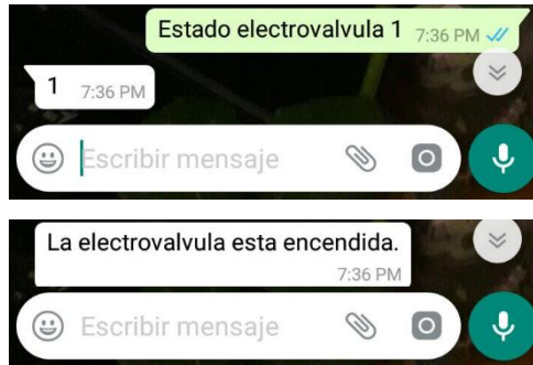
Figura 4.29 Consulta del estado de la electroválvula
