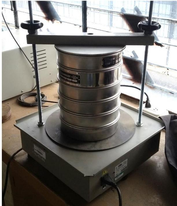
Fotografía 9. Tamizado de la muestra de suelo para análisis granulométrico
