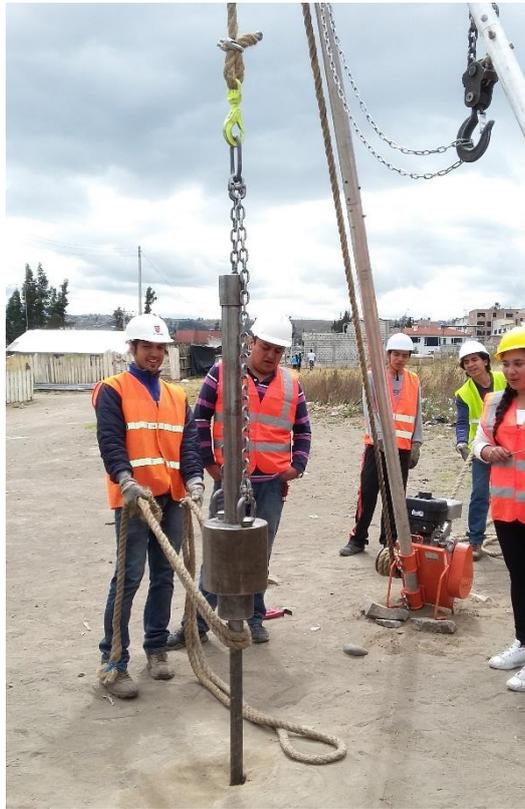
Fotografía 5. Realizando el ensayo SPT
