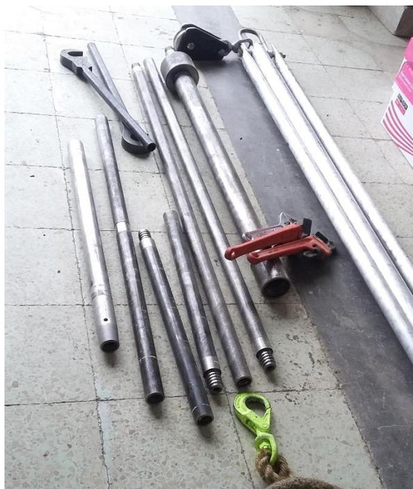
Fotografía 2. Equipos para el ensayo SPT
