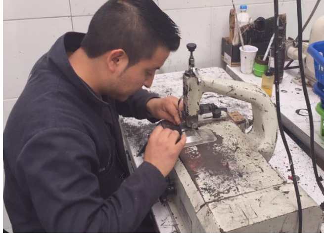
Figura 20 Destallado para doblados de cuero. Fuente: Planta de producción Calzado Liwi.
