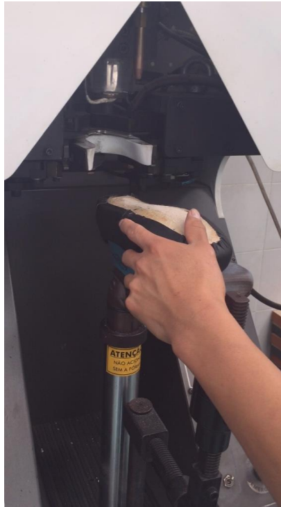
Figura 30 Proceso de armado, máquina armadora de talones. Fuente: Planta de producción Calzado Liwi.
