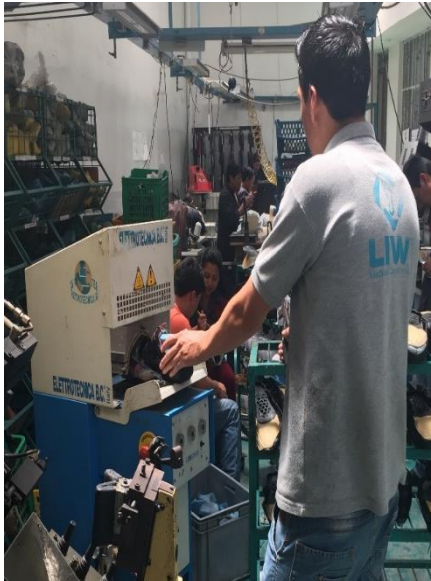
Figura 26 Proceso de armado, máquina reactivadora de capellada. Fuente: Planta de producción Calzado Liwi.
