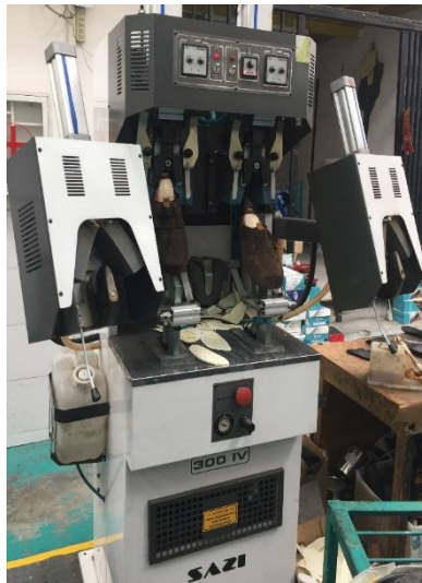
Figura 24 Proceso de pre-armado, máquina conformadora de talones. Fuente: Planta de producción Calzado Liwi.
