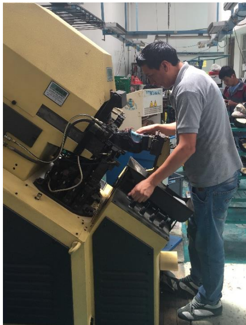
Figura 27 Proceso de armado, máquina armadora de punta. Fuente: Planta de producción Calzado Liwi.
