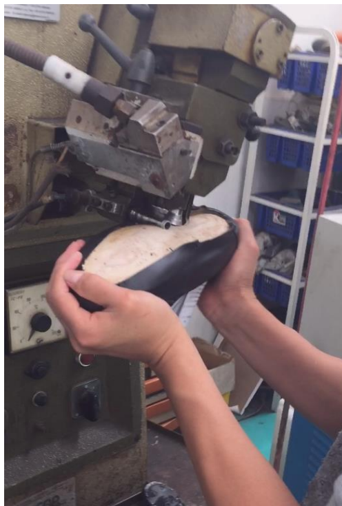
Figura 29 Proceso de armado, máquina armadora de lados Fuente: Planta de producción Calzado Liwi.
