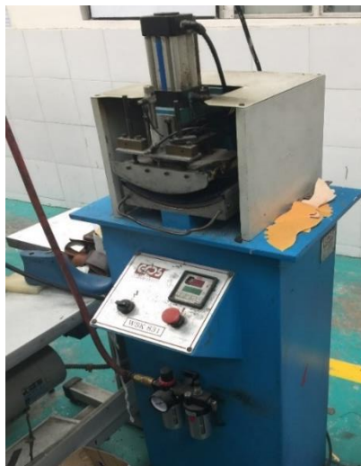
Figura 23 Proceso de pre-armado, máquina fijadora de puntas. Fuente: Planta de producción Calzado Liwi.
