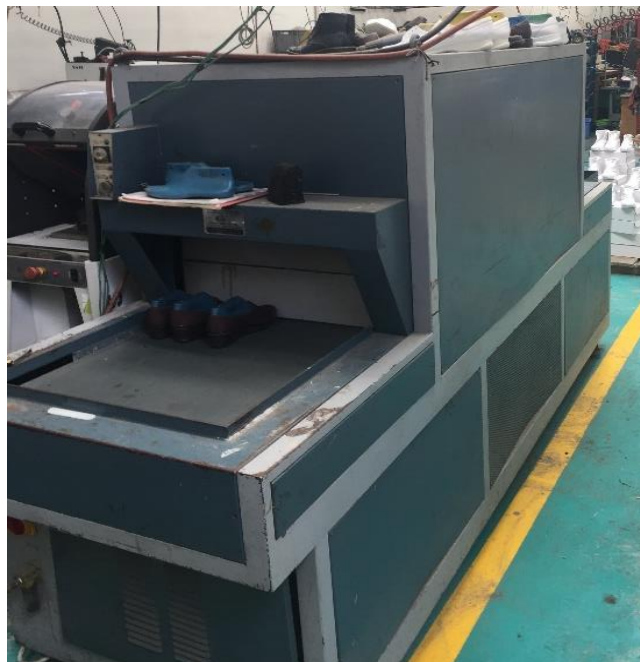
Figura 34 Proceso de plantado, túnel de frío. Fuente: Planta de producción Calzado Liwi.
