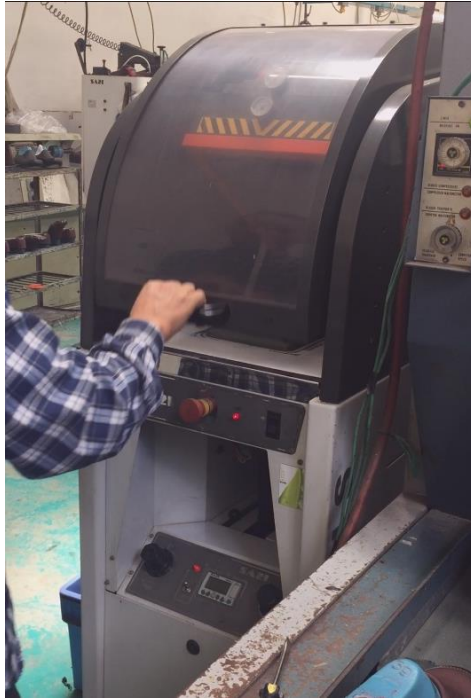
Figura 33 Proceso de plantado, máquina prensadora. Fuente: Planta de producción Calzado Liwi.
