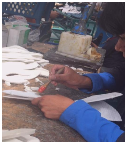
Figura 21 Proceso de aparado, pegado de piezas. Fuente: Planta de producción Calzado Liwi.
