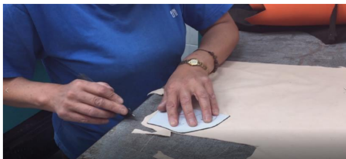
Figura 16 Corte manual de cuero. Fuente: Planta de producción Calzado Liwi
