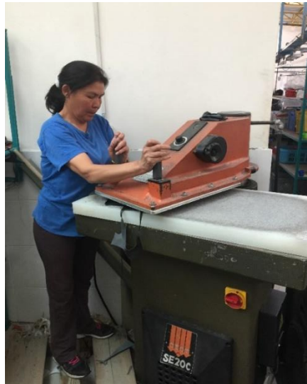
Figura 15 Corte con troquel de cuero. Fuente: Planta de producción Calzado Liwi.
