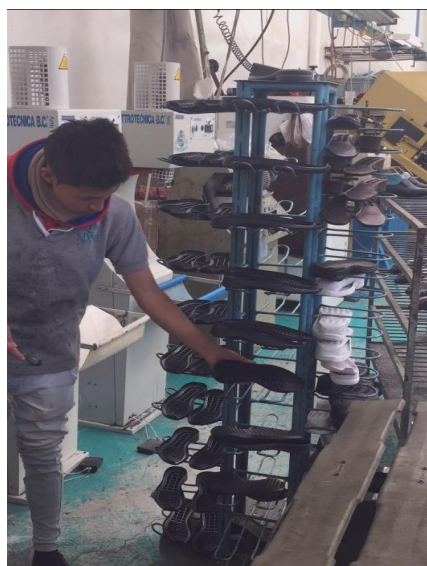
Figura 31 Proceso de armado, preparado de plantas. Fuente: Planta de producción Calzado Liwi.
