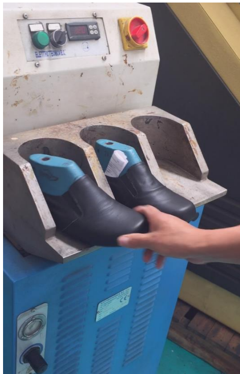
Figura 28 Proceso de armado, máquina reactivadora de talones Fuente: Planta de producción Calzado Liwi.
