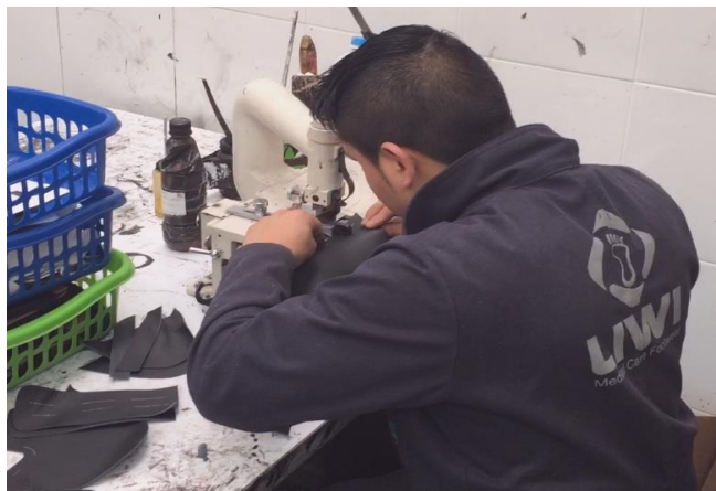
Figura 19 Destallado donde se baja el calibre de cuero. Fuente: Planta de producción Calzado Liwi.
