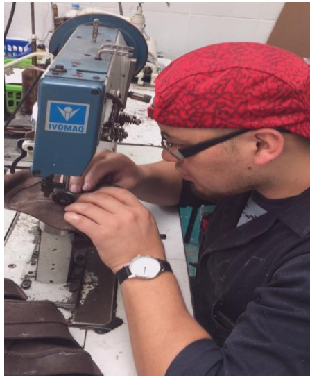
Figura 22 Proceso de aparado, costura de piezas Fuente: Planta de producción Calzado Liwi
