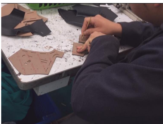
Figura 17 Rayado de cuero. Fuente: Planta de producción Calzado Liwi.
