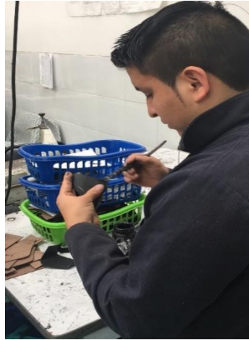
Figura 18 Pintado de cuero. Fuente: Planta de producción Calzado Liwi.
