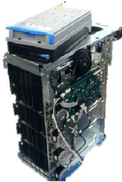
Figura 20. Dispensador de Billetes, marca DIEBOLD. [10]
