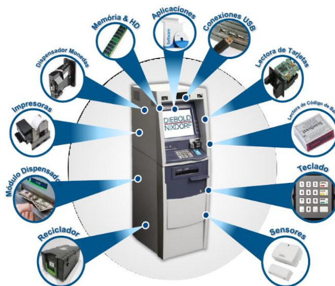
Figura 23. Componentes Constitutivos del Cajero Automático. [23]
