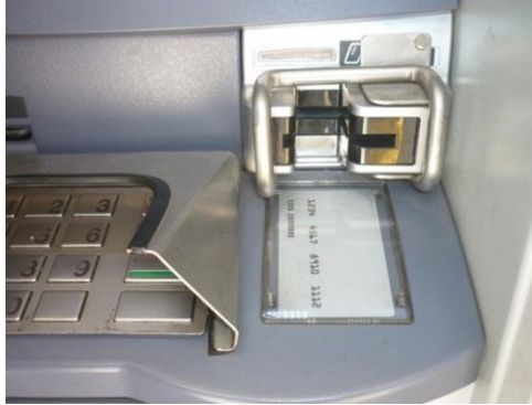
Figura 27. Protector Metálico de la Lectora y del Teclado Elaborado por: El Autor
