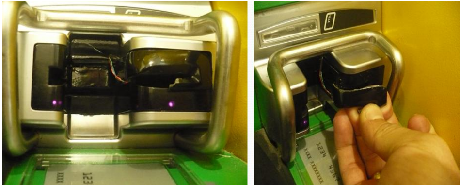
Figura 308.- Instalación de Lectoras Falsas Elaborado por: El Autor
