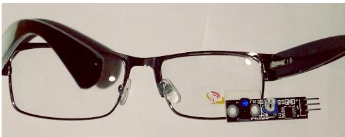
Figura 4.5: Ubicación del sensor en los lentes
