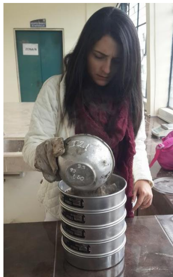
Fotografía 11. Muestras colocadas en el Juego de tamices
