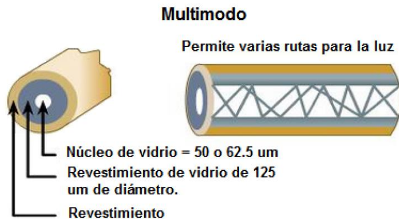
Figura 2.7. Fibra óptica multimodal (MM). [10]
