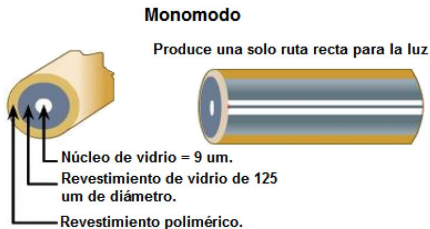
Figura 2.8. Fibra óptica monomodo (SM). [10]
