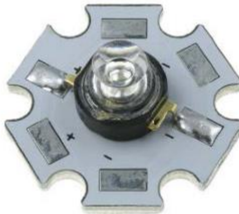
Figura 2.12. Diodo emisor de luz de tipo lateral. [12]
