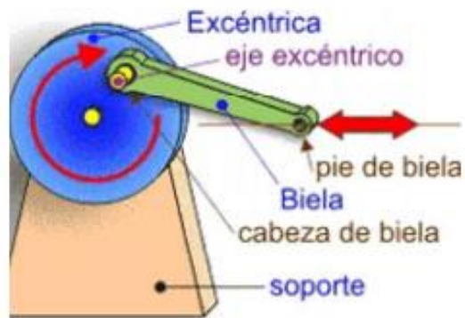
Figura 36. Eje excéntrico adaptado a una biela [29]
