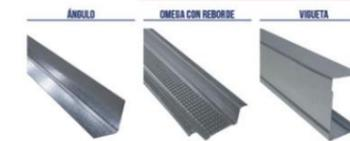
Perfil en forma de L se instala sobre las muros perimetrales y ayuda a determinar el nivel del falso piso. También se utiliza como elemento de soporte para la estructura de la cubierta y la estructura de falso piso.
