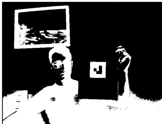
Fig. 4.17: Detección de marcador por umbralización.
