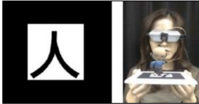
Fig. 2.18: Izquierda: marcador predefinido. Derecha: realidad aumentada montada sobre el marcador [51].
