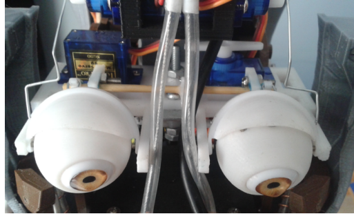
Figura. 4.3.1.5. Mecanismo para el movimiento de ojos y párpados.
