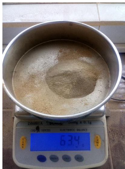
Fotografía 8. Pesando el suelo retenido en la base
