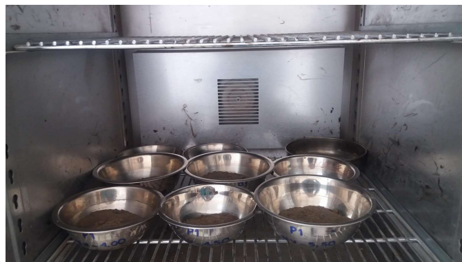
Fotografía 6: Muestra de suelo en horno
