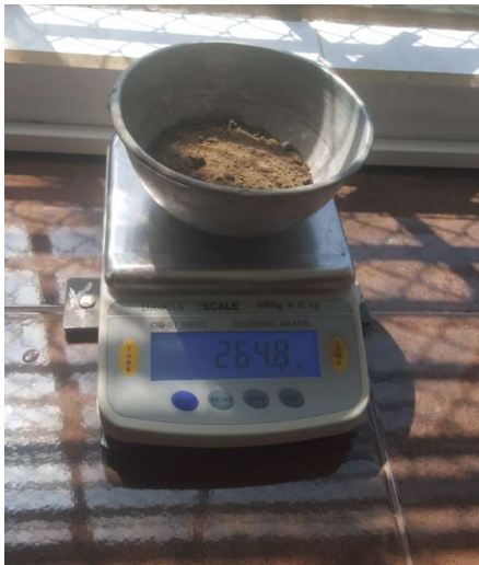
Fotografía 5: Pesando la Muestra de Suelo
