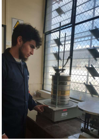
Fotografía 7: Tamizando la muestra de suelo
