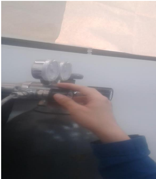
Abrir la válvula del tanque y la válvula de paso del oxígeno
