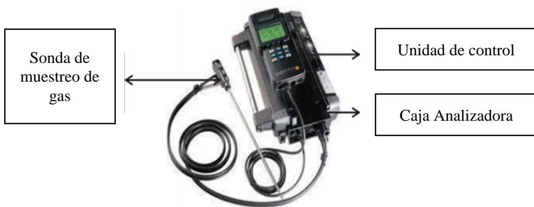
Gráfico N° 34. Analizador de gases marca Testo 350 M/XL Fuente: (Testo AG, 2007, pág. 61)
