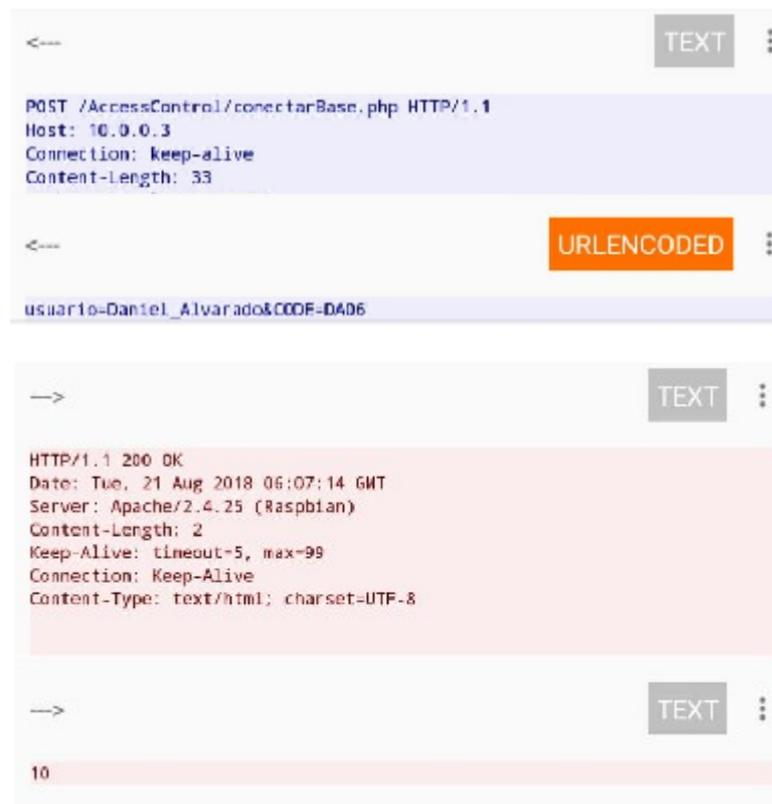
*Fig.4. 16: Captura de datos de la cabecera HTTP enviada de Módulo de Control de Acceso al Servidor.*
