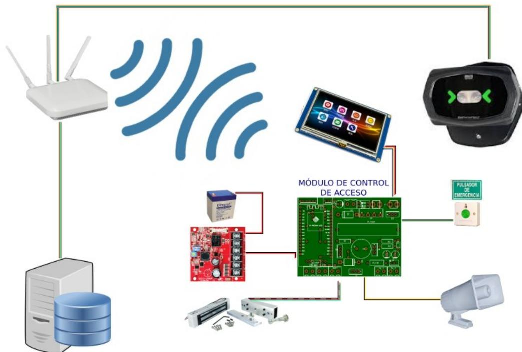
*Fig.4. 7: Diagrama físico del sistema de control de acceso.*
