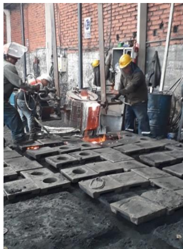
Figura 4. 2 Colado de material en modelo de probeta de hierro nodular.
