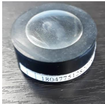
Figura 4. 16 Probeta pulida y atacada con nital 2. Fuente: Autor.
