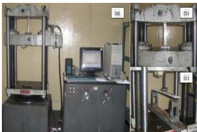
Figura N° 2.14: (a) Máquina universal de ensayos Tinius Olsen modelo Súper L. (b) Mordazas Cuneiformes. (c) Set de flexión a tres puntos.
