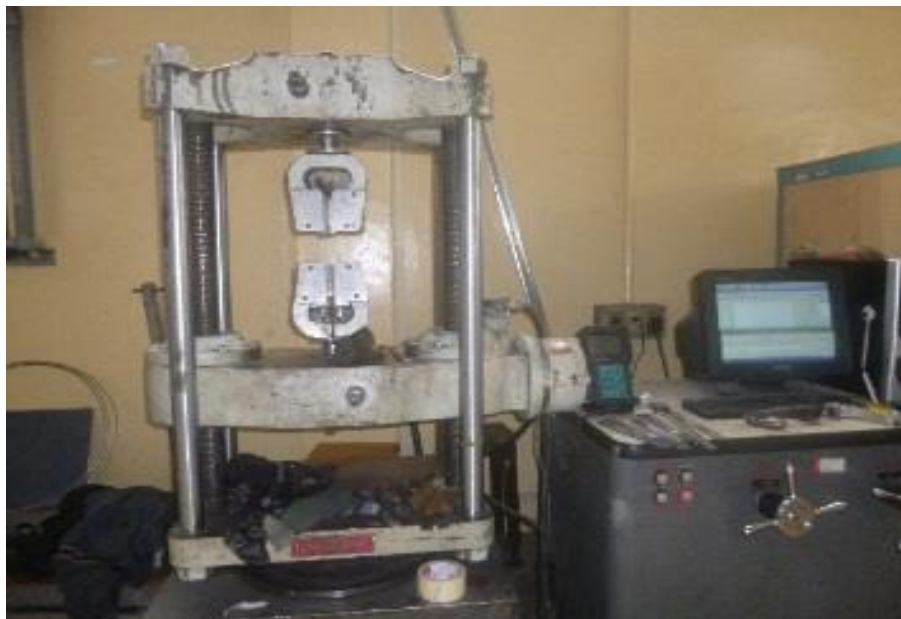
Figura N° 4.6: Dimensionamiento de la Probeta Bajo la norma ASTM D3039-00 y Maquina Universal de ensayos Tinius Olsen, modelo H25KS
