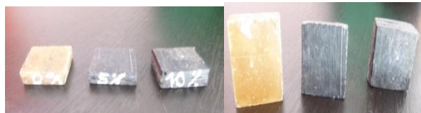
Figura N° 4.20: Probetas para ensayo de adherencia resina poliéster y fibra vidrio + nanotubos de carbono.
