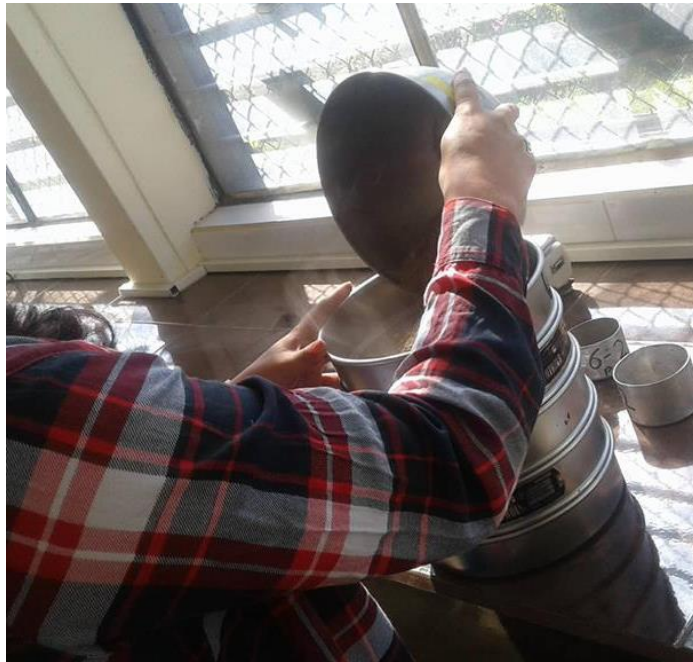
Fotografía 10.- Colocando la muestra de suelo en los tamices.
