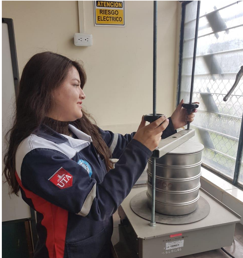
Fotografía 11.- Tamizando las muestras obtenidas en el ensayo.
