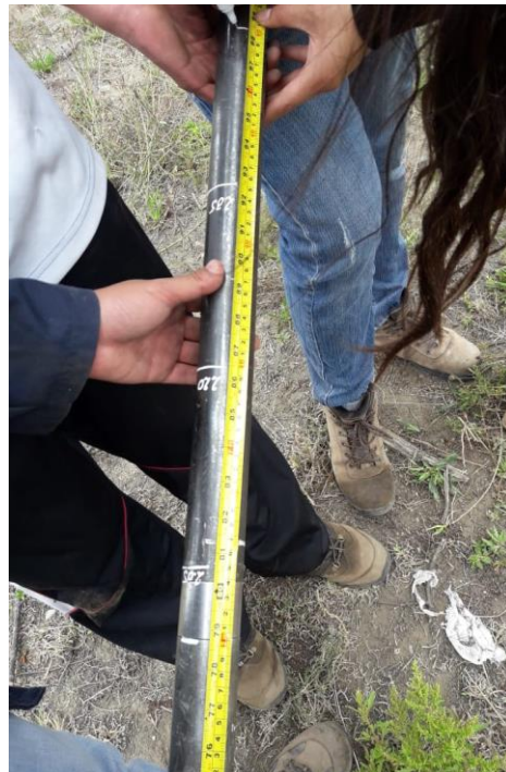
Fotografía 4.- Colocación de medidas en los tubos de penetración.
