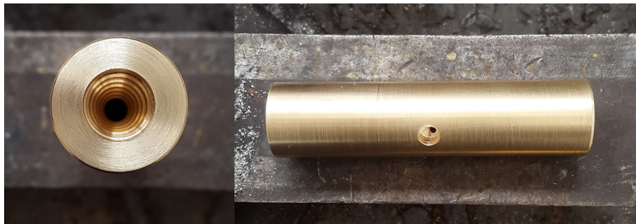
Figura 2.22: Tubo venturi Fuente: [Autor]
