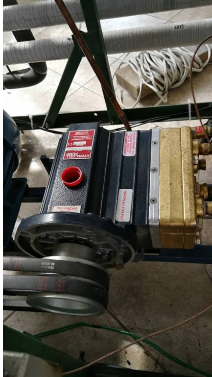
Figura 2.23: Bomba de membranas, sistema auxiliar de inyección de líquido.
