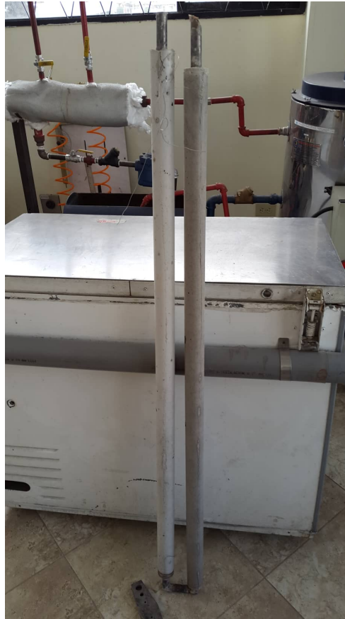
Figura 2.11: Capa final de cemento refractario Fuente: [Autor]
