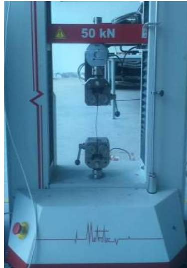
Figura 3.15.- Ensayo de tracción en máquina MTE-50. [Autor]
