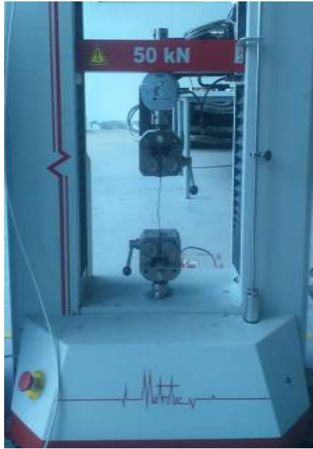
Figura 3.23.- Ensayo de flexión en máquina MTE-50. [Autor]
