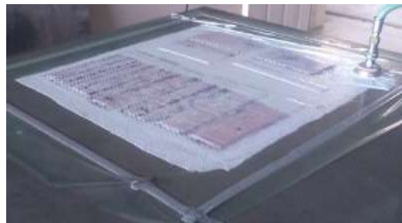
Figura 3.19.- Pegado de bagging film. [Autor]
