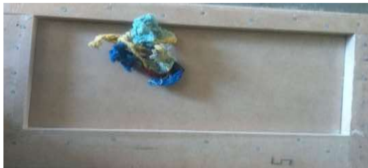
Figura 3.7.- Aplicación de cera desmoldante. [Autor]
