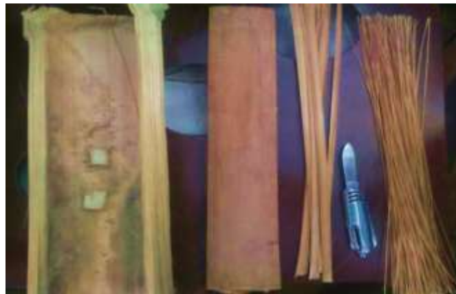
Figura 3.2.- Obtención de la fibra de caña guadua. [Autor]
