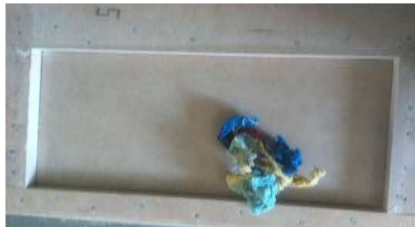
Figura 3.16.- Aplicación de cera desmoldante. [Autor]
