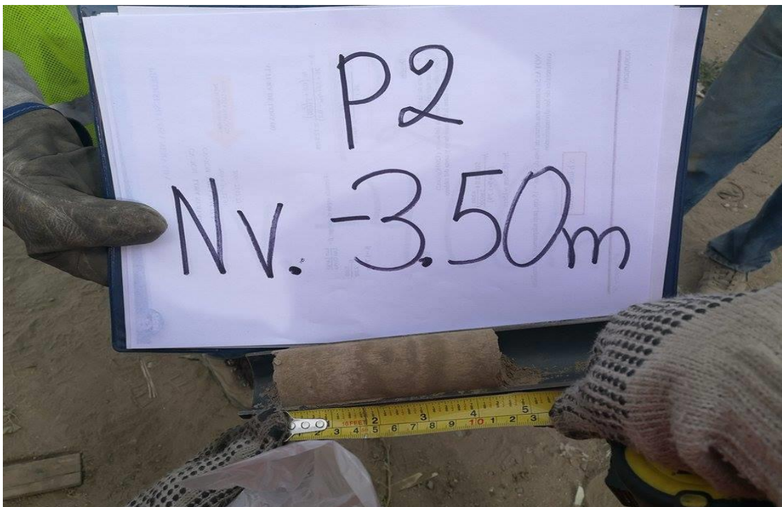
Fotografía 10. Muestra obtenida a la máxima profundidad permitida – Pozo 2
