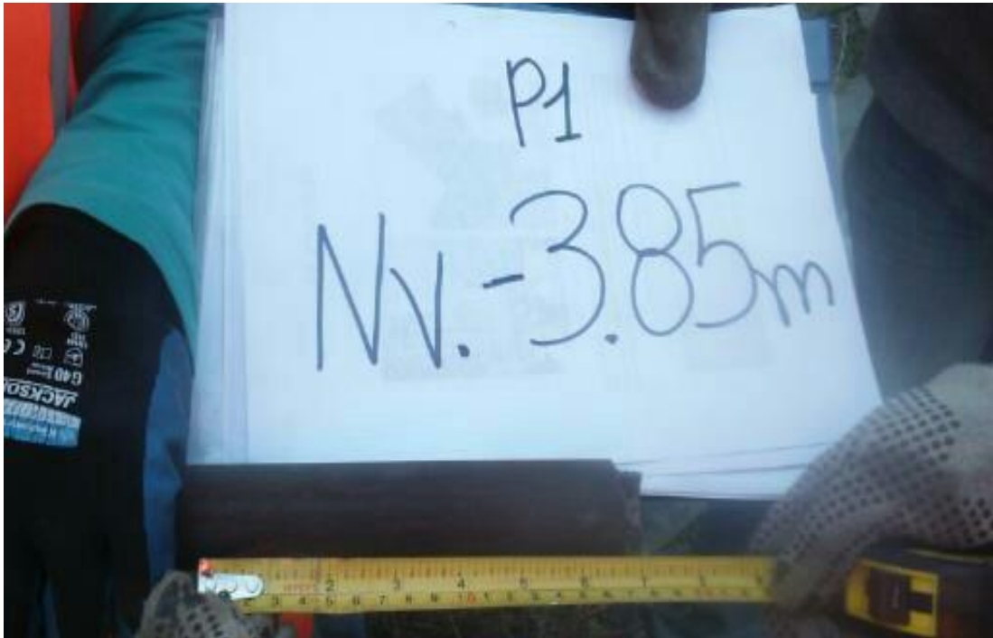
Fotografía 9. Muestra obtenida a la máxima profundidad permitida – Pozo 1
