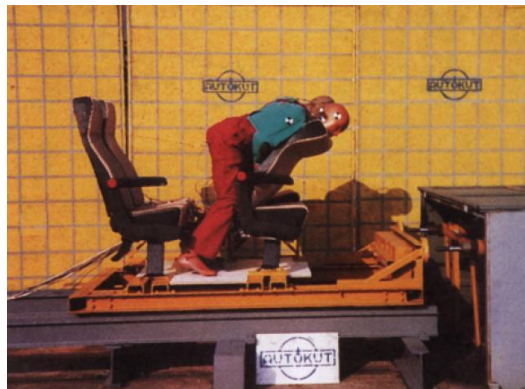
Fig. II.2: Ensayo de un asiento doble con empotramiento tipo riel acorde a ECE R80 [14].
