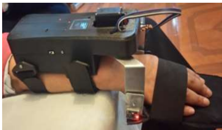
Fig. 4.98.- Prototipo de Prótesis Electrónica para la Rehabilitación del Síndrome del Túnel del Carpo
