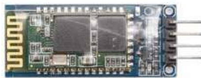
Fig. 2.14.- Modulo Bluetooth compatible con Arduino y PIC [31].
