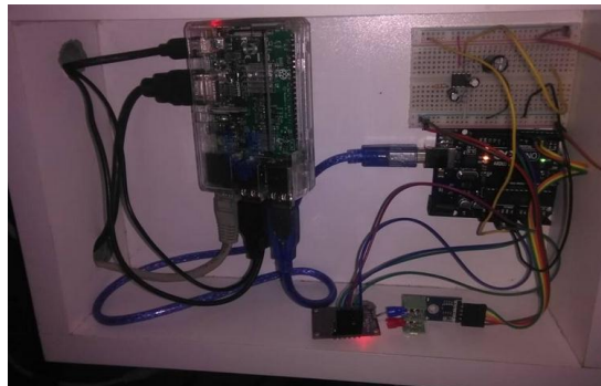
Fig 4.11. Conexión de sensor de frecuencia cardíaca y temperatura Elaborado por: Víctor Tomalá
