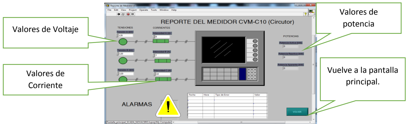
Figura 27: Pantalla Reporte Medidor y Alarmas.
