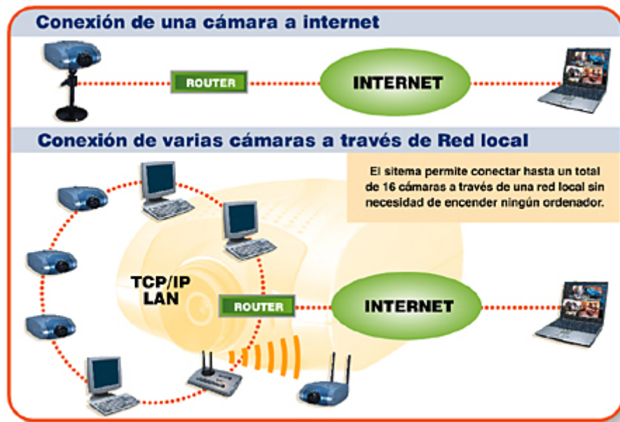
Figura N° 6.17. Conexión Cámara IP
