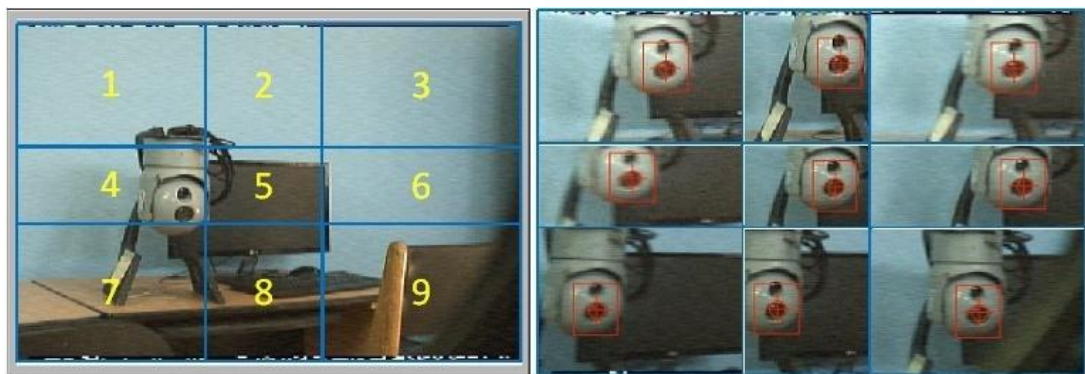
Fig. 6.89 División de cuadrantes del video a colores del sistema T-Stamp aplicando el filtro por forma.
