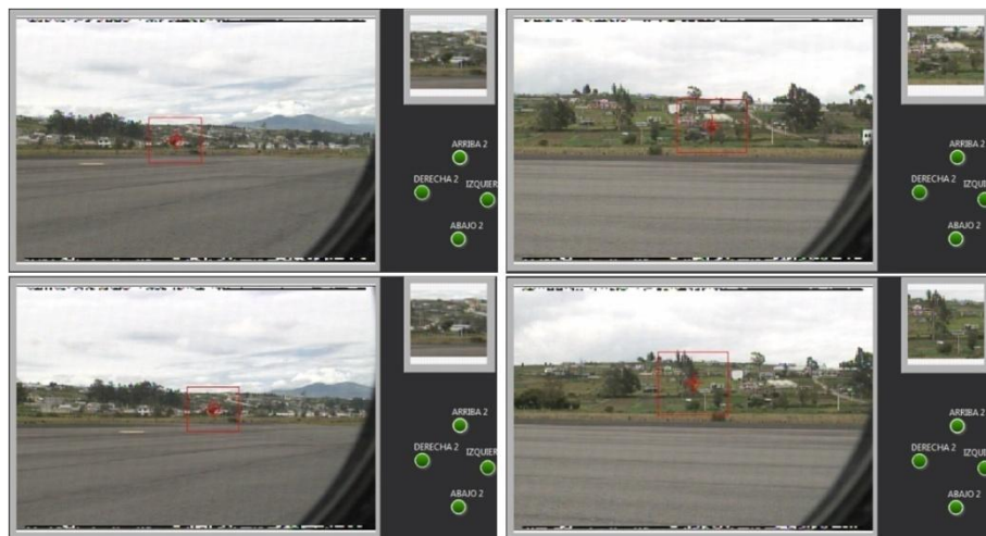
Fig. 6.99 Pruebas de tracking automático en la pista de aterrizaje con el sistema TU-STAMP en video a color.
