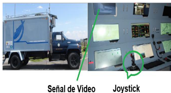
Fig. 6.60 Estación de mando y control en tierra. Elaborado por: El investigador
