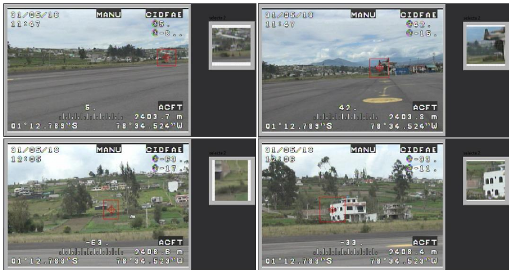
Fig. 6.97 Pruebas de tracking automático en la pista de aterrizaje con el sistema SEO en video a color.
