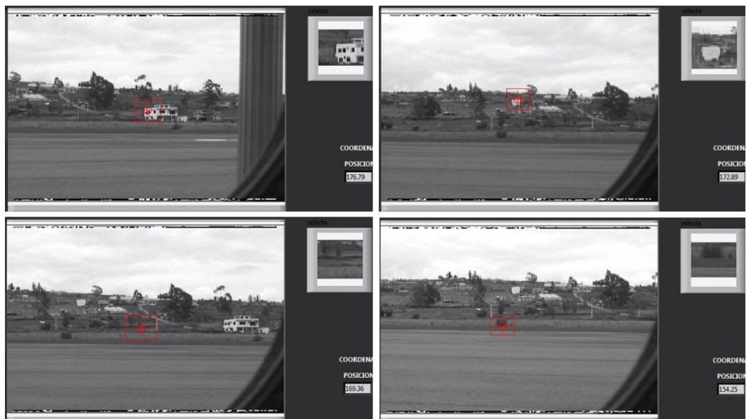
Fig. 6.98 Pruebas de tracking automático en la pista de aterrizaje con el sistema T-Stamp en video a escala de grises.
