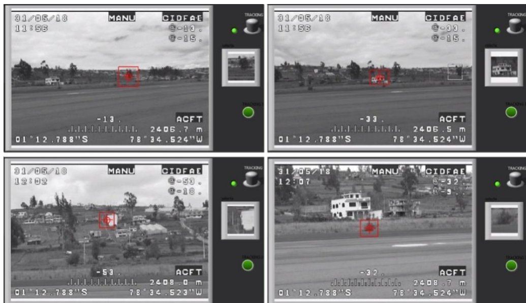
Fig. 6.96 Pruebas de tracking automático en la pista de aterrizaje con el sistema SEO en video a escala de grises.
