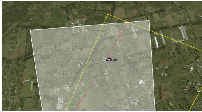
Fig. 6.58 Simulación realizada para la verificación del rango de cobertura de los sistemas electro-ópticos a 1000m sobre una superficie de terreno.
