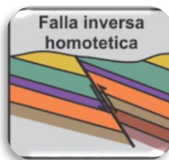
Ilustración 12. Falla Inversa Homotética
