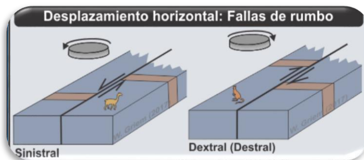
Ilustración 15. Fallas de rumbo
