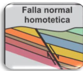
Ilustración 9. Falla Normal Homotética
