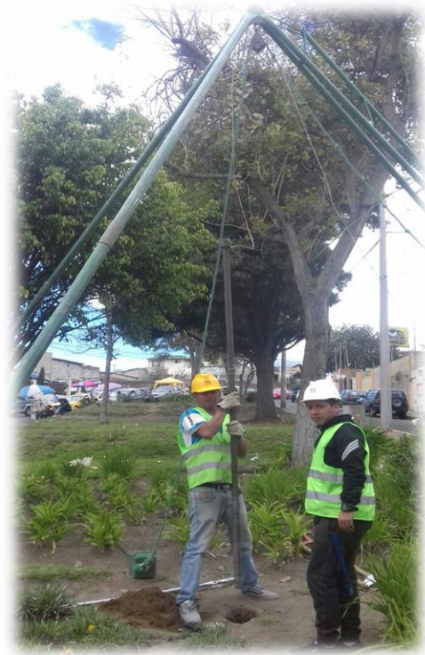
Fotografía 5. Obtención de muestra con tubo receptor.
