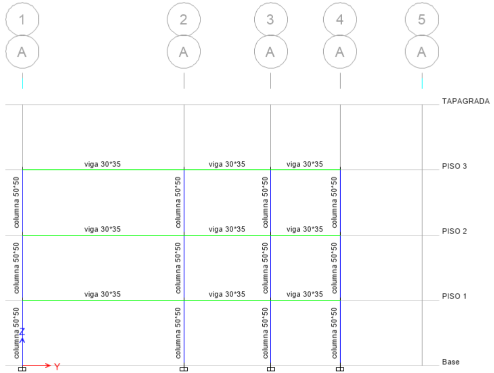
Figura 52. Vista en elevación de segunda edificación tipo
