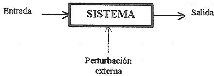
Figura 3 Partes de un sistema [18]
