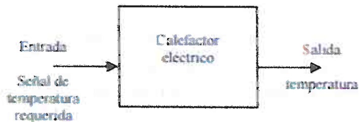
Figura 5 Sistemas de control de Lazo Abierto [18]
