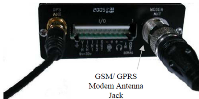
Figura 6.41: Conexión de la antena al Módem Enfora SA-GL
