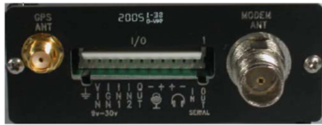
Figura 6.40: Panel trasero Módem Enfora SA-GL
