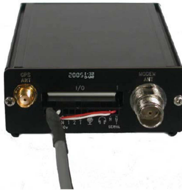
Figura 6.43: Instalación del cable de alimentación
