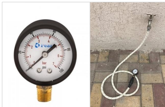
Figura 21: Manómetro con conexión inferior acoplado al grifo de agua potable
