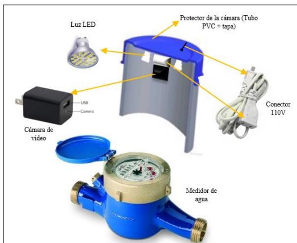
Fuente: Medidor marca Malveco
