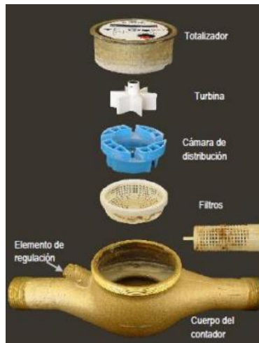
Figura 5: Mecanismo del medidor de chorro múltiple
