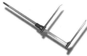
Figura 12. Cabeza deslizante del antropómetro. De: Ridder J. Normas Internacionales para la Valoración Antropométrica. School of Biokinetics, Recreation and Sport Science. 2014.
