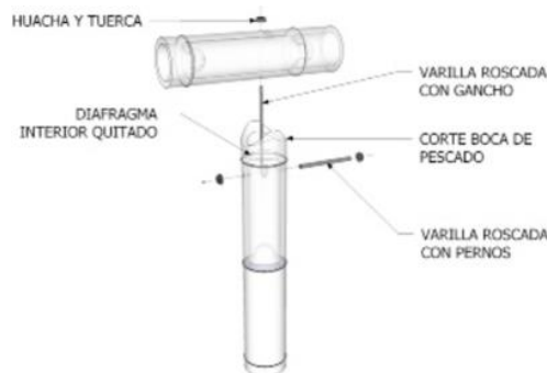
Imagen 48: Perno tensor Fuente: (Ubidia, 2015)
