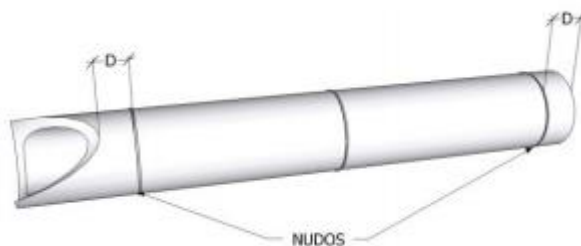
Imágen 1: Las piezas de bambú, no se deben unir con clavos Fuente: (Vivienda, 2017, pág. 17)
