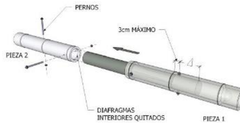
Imágen 44: Uniones Longitudinales Fuente: (Ubidia, 2015)
