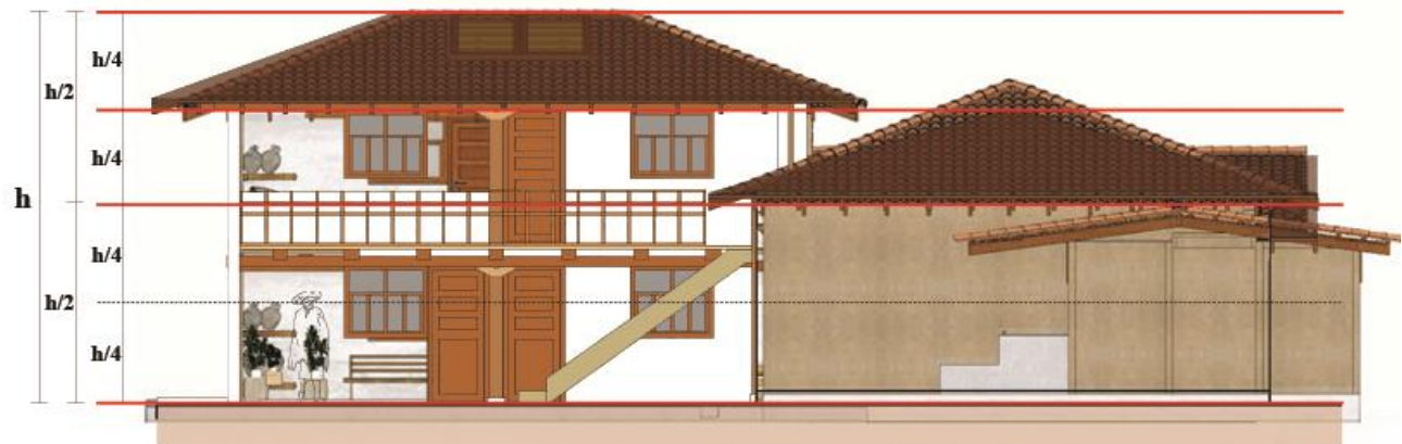
Ilustración: La altura de la cubierta equivale al 1/4 de la de la altura del piso al alero, de tal forma que la pendiente es aproximadamente al 20 %.
