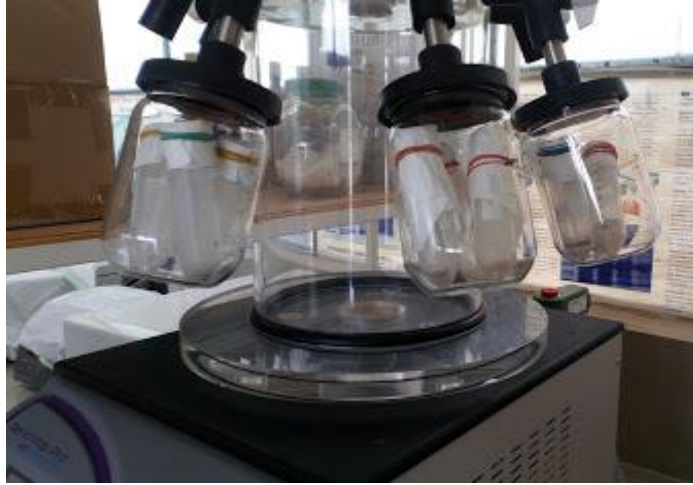
Figura 26. Liofilización de la proteína precipitada del gandul verde (pH 3,0) y del gandul maduro (pH 4,0)
