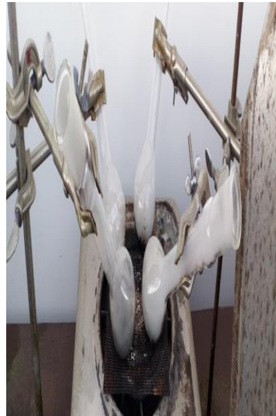
Figura 29. Digestión por MicroKjeldahl de los concentrados proteicos de gandul maduro
