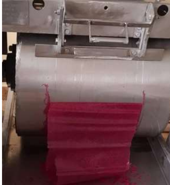
Figura C.5. Secado de papilla de mora en el secador de tambor rotatorio
