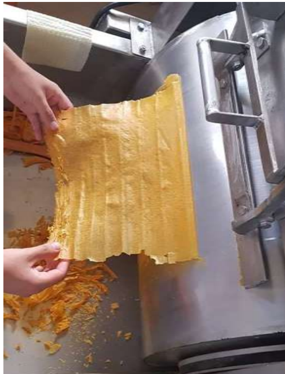
Figura C.4. Secado de papilla de taxo en el secador de tambor rotatorio
