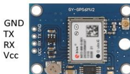
Figura 4.6. Especificaciones de conexión del sensor GPS Fuente: Módulo Plug & Play del GPS NEO 6M [37]
