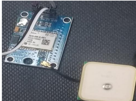
Figura 4.29. Conexión GPS NEO 6M
