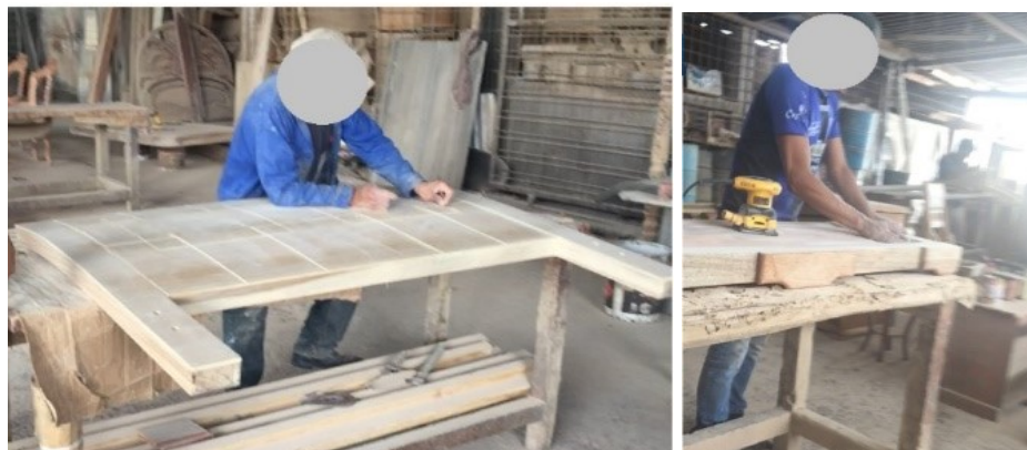
Figura 33. Lijado de madera Fuente: Artecua S.A.
