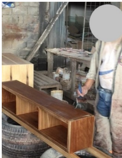
Figura 36. Aplicación de sellador Fuente: Artecua S.A.
