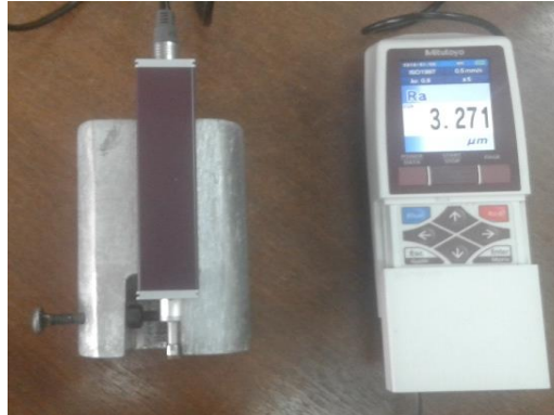
Figura 2.19. Medición de la rugosidad de las superficies expuestas al láser. Fuente: Autor
