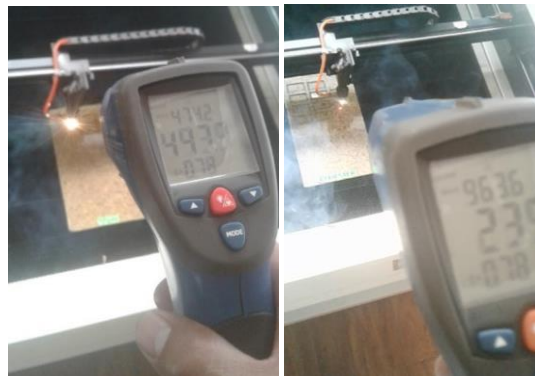
Figura 2.20. Medición de las temperaturas superficiales del material expuesto al láser. Fuente: Autor
