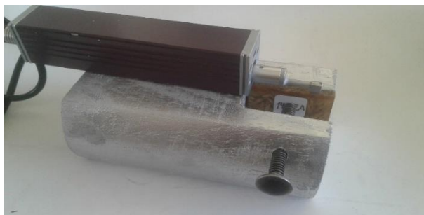
Figura 2.18. Ubicación adecuada de la probeta y el palpador. Fuente: Autor
