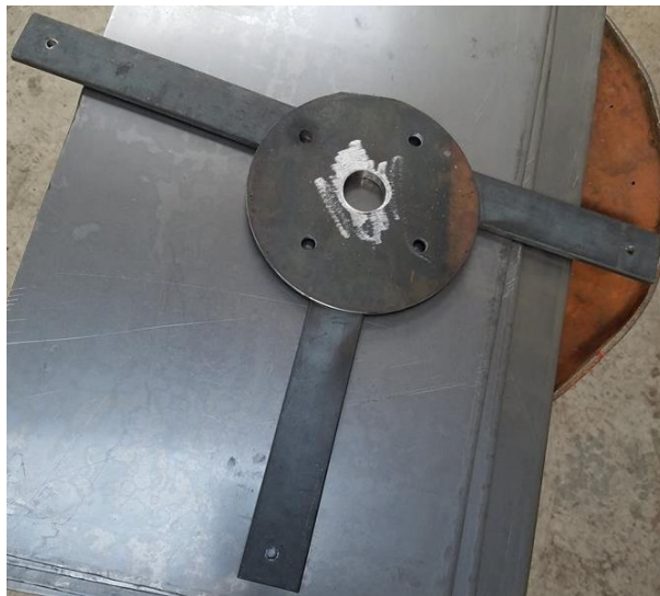
Figura 64: Construcción del soporte de chumacera
