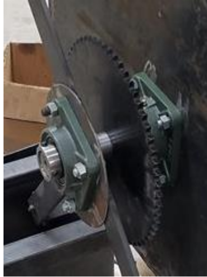
Figura 75: Montaje de chumaceras
