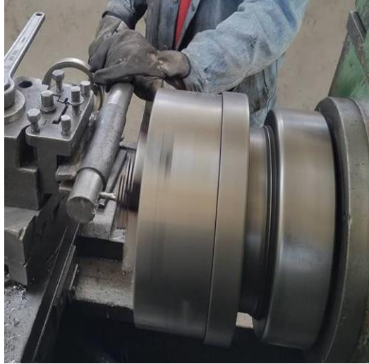
Figura 73: Mecanizado del eje de transmisión
