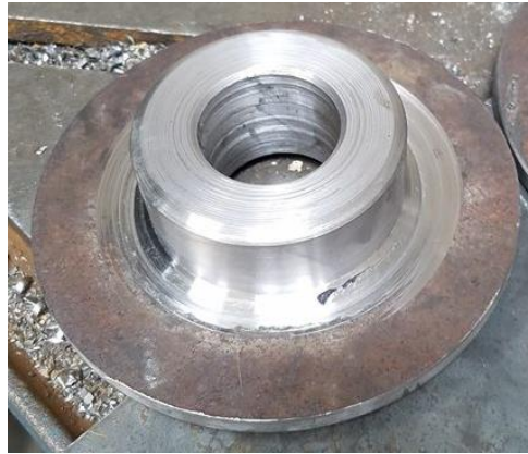
Figura 65: Construcción de la brida de rotor
