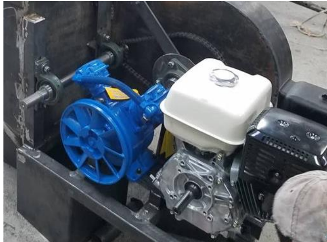
Figura 77: Montaje del cabezal de compresor
