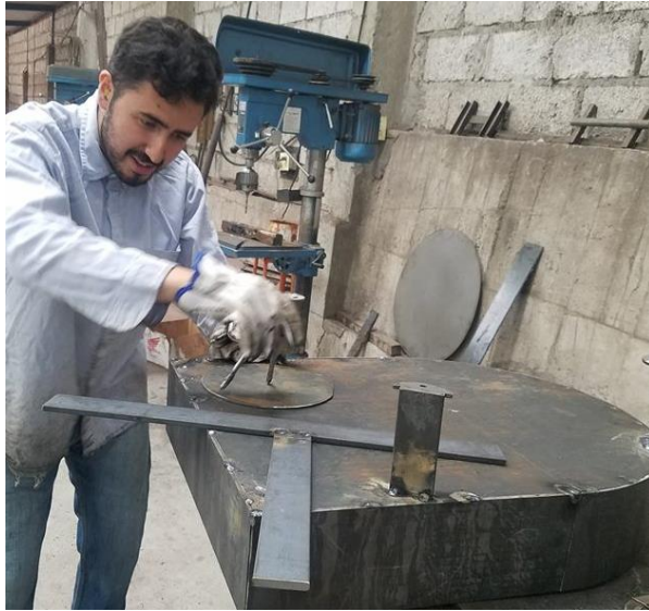
Figura 63: Construcción del soporte de la bomba
