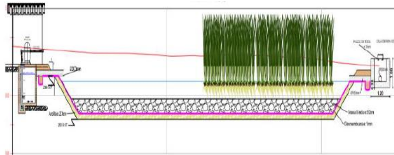
Figura 10. Humedal artificial de flujo subsuperficial Fuente: (GADBAS; 2017)
